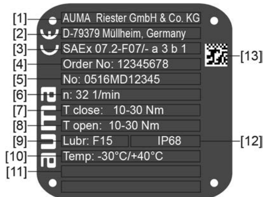
рис. 2: Заводская табличка электропривода (пример)
