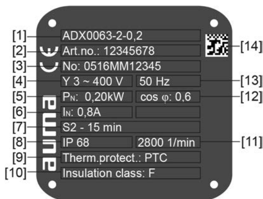
рис. 4: Заводская табличка двигателя (пример)
