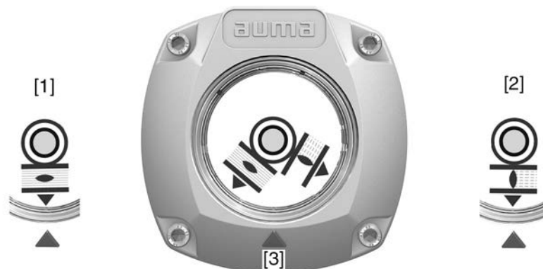
рис. 73: Механический указатель положения
