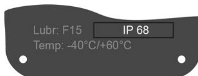
рис. 28: Заводская табличка, пример для класса защиты IP68
