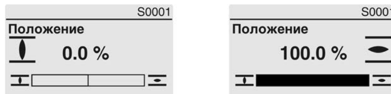
рис. 61: Достигнуто конечное положение ОТКРЫТО/ЗАКРЫТО
