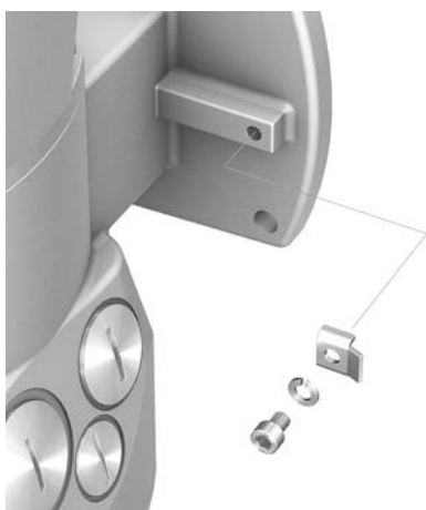
рис. 35: Заземление настенного крепления
