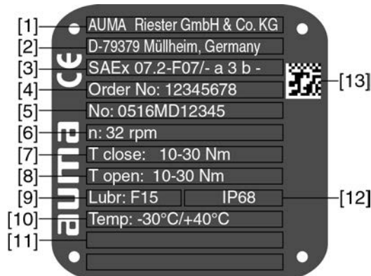
рис. 2: Заводская табличка электропривода (пример)
