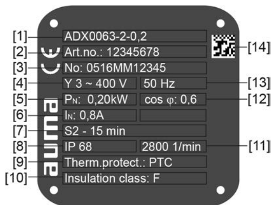
рис. 3: Заводская табличка двигателя (пример)
