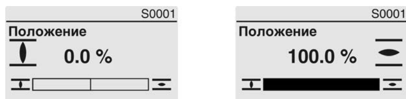
рис. 42: Достигнуто конечное положение ОТКРЫТО/ЗАКРЫТО
