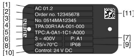
рис. 3: Заводская табличка блока управления электроприводом (пример)
