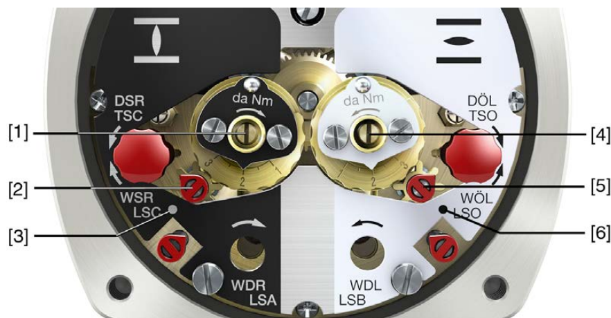
рис. 56: Регулировочные элементы концевого выключателя
