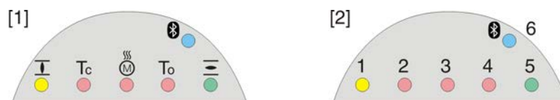
рис. 55: Расположение ламп и описание ламповой индикации
