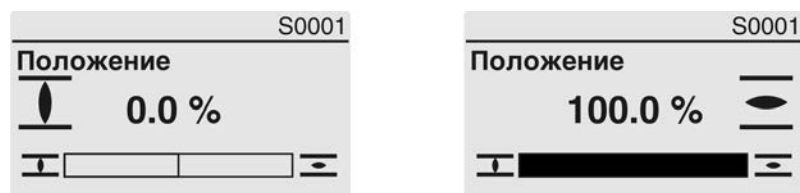
рис. 42: Достигнуто конечное положение ОТКРЫТО/ЗАКРЫТО
