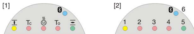
рис. 73: Расположение ламп и описание ламповой индикации
