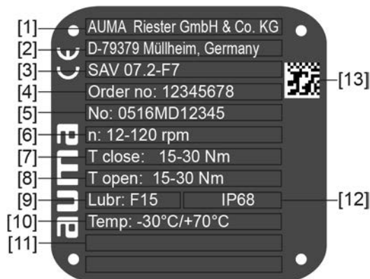
рис. 2: Заводская табличка электропривода (пример)
