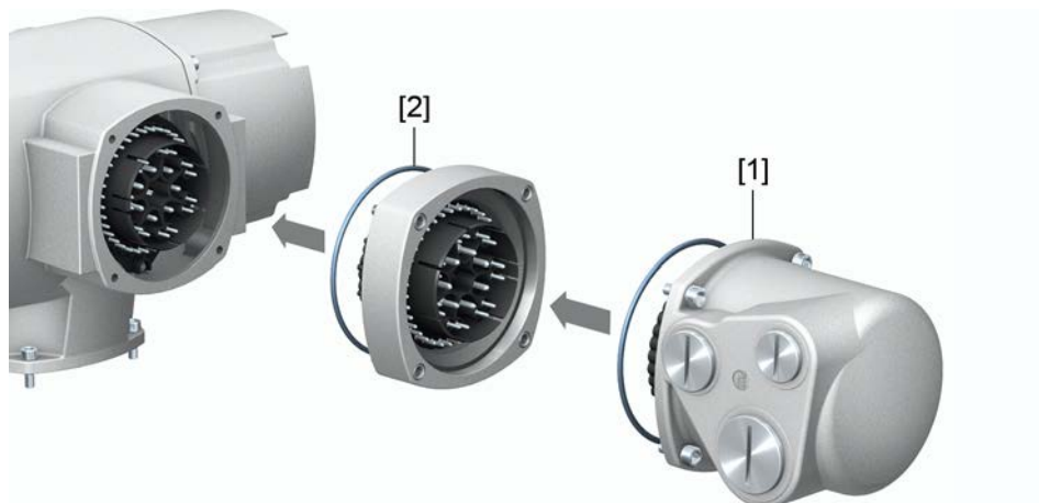
рис. 24: Электрическое подключение с промежуточной рамкой
