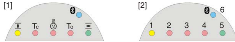
рис. 55: Расположение ламп и описание ламповой индикации
