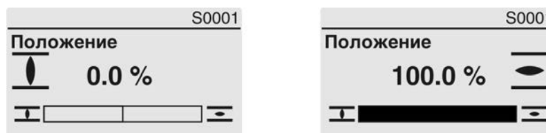
рис. 47: Достигнуто конечное положение ОТКРЫТО/ЗАКРЫТО
