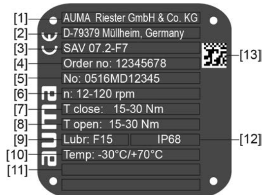
рис. 2: Заводская табличка электропривода (пример)
