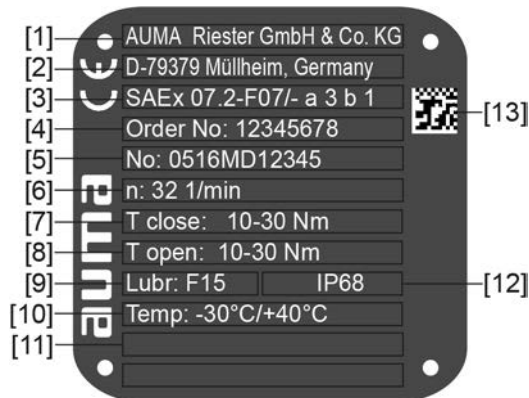
рис. 2: Заводская табличка электропривода (пример)
