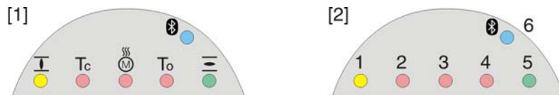
рис. 71: Расположение ламп и описание ламповой индикации
