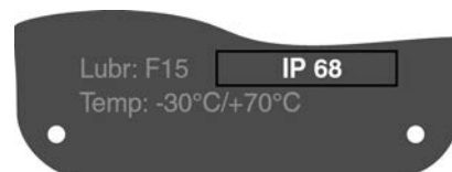
рис. 33: Пример: заводская табличка для степени защиты IP 68
