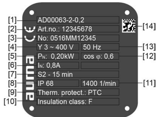
рис. 4: Заводская табличка двигателя (пример)
