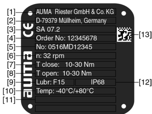
рис. 2: Заводская табличка электропривода (пример)
