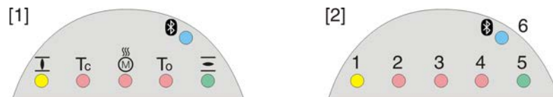
рис. 61: Расположение ламп и описание ламповой индикации
