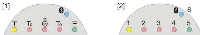
рис. 54: Расположение ламп и описание ламповой индикации
