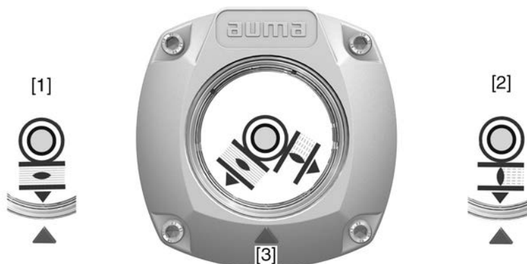
рис. 73: Механический указатель положения
