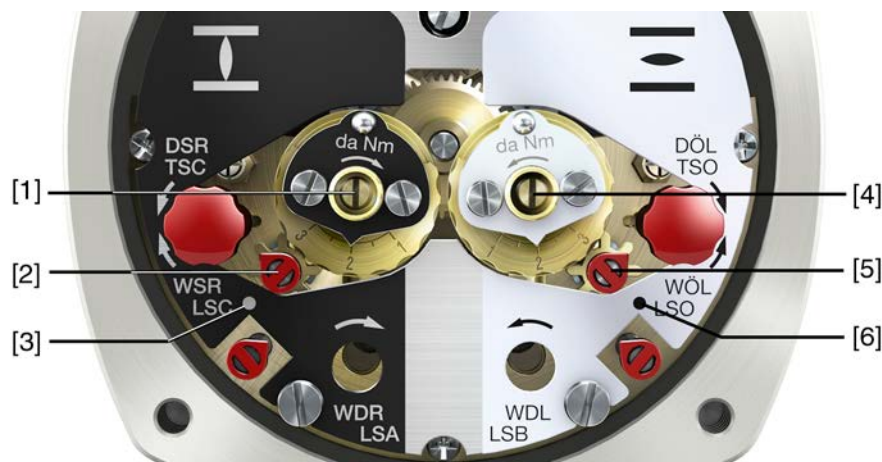
рис. 75: Регулировочные элементы концевого выключателя
