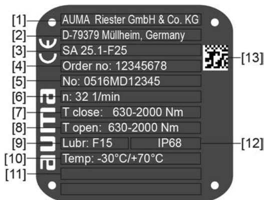
рис. 4: Заводская табличка электропривода (пример)
