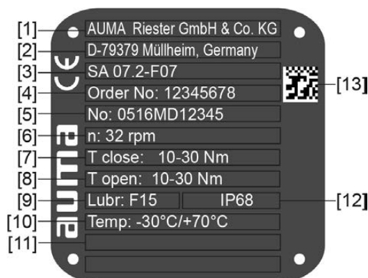
рис. 2: Заводская табличка электропривода (пример)
