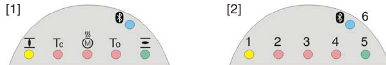
рис. 56: Расположение ламп и описание ламповой индикации
