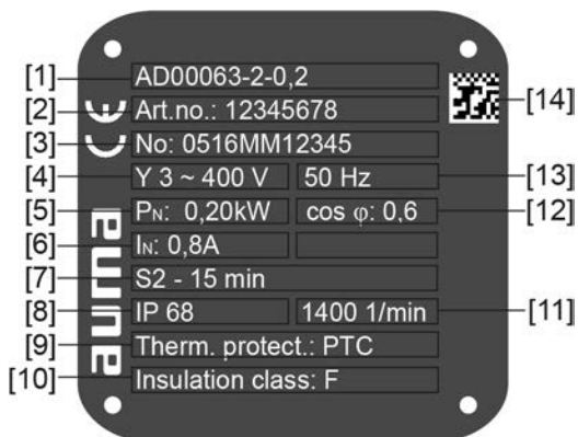
рис. 4: Заводская табличка двигателя (пример)
