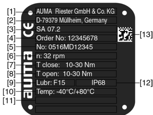
рис. 2: Заводская табличка электропривода (пример)
