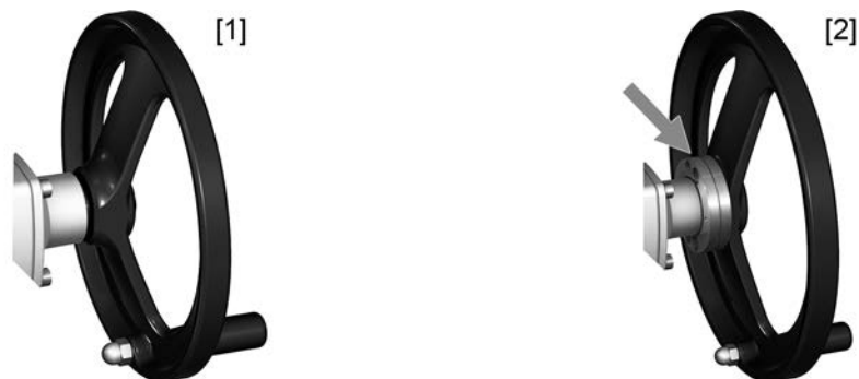
рис. 28: Маховик с защитой / без защиты от перегрузки
