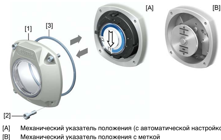
рис. 64: Снятие/установка крышки отсека выключателей
