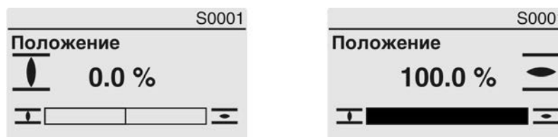
рис. 43: Достигнуто конечное положение ОТКРЫТО/ЗАКРЫТО
